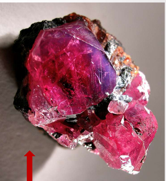
Rubino, ione cromo circondato da ossido di alluminio.
